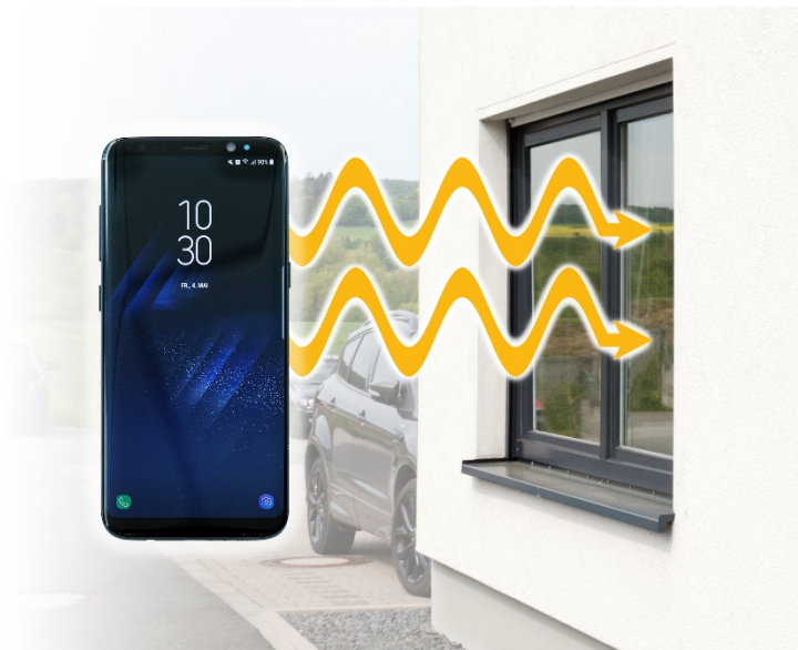
Bild 2: Die Durchlässigkeit für den Mobilfunk erhöht sich durch die Veredelung mit dem Laser signifikant und ist nach der Bearbeitung vergleichbar mit der einer unbeschichteten Glases.
